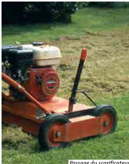
Passage du scarificateur
