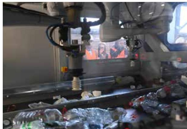
Machine de tri optique pour différencier les types d'emballages
